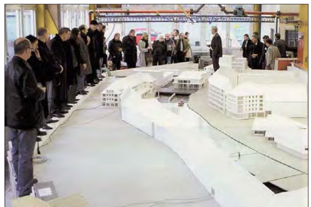
図-5 街並みを再現した水理実験模型(文献8抜粋)
