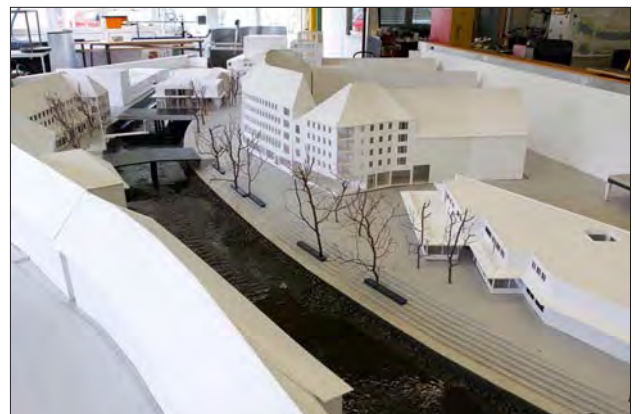
図-8 コンペ案を反映した水理実験模型（文献10 抜粋）
