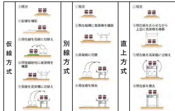
図-2 施工方法による高架下空間の違い 7)
