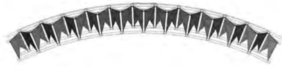
図-11 弧状線の構造物_ヨシムラ折り適用例
