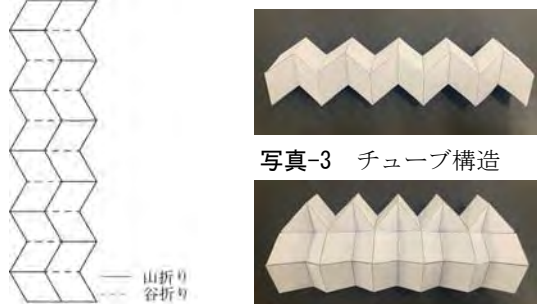
図-2 ミウラ折り一部展開図 写真-4 複合チューブ構造
