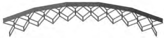
図-10 弧状線の構造物_複合チューブ構造適用例
