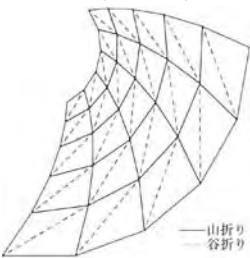
図-7 筒型らせん折り展開図 (円錐型)
