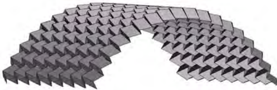
図-13 3D面的構造物_ミウラ折り適用例
