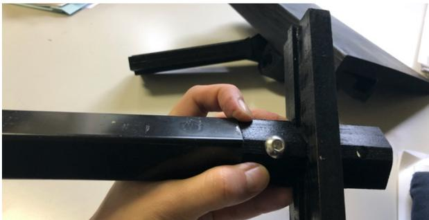
写真-4 柵の接合部のモックアップ(1/1)
