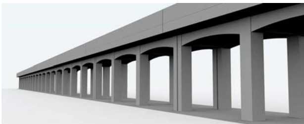
図-26 背割り式・曲線ハンチ(梁幅<柱幅)
