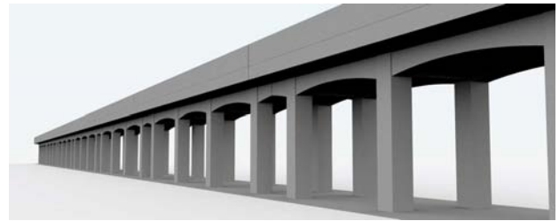
図-30 張出し式・曲線ハンチ(梁幅<柱幅)
