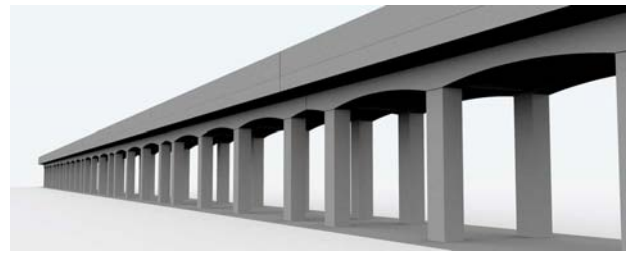
図-29 張出し式・曲線ハンチ(梁幅>柱幅)
