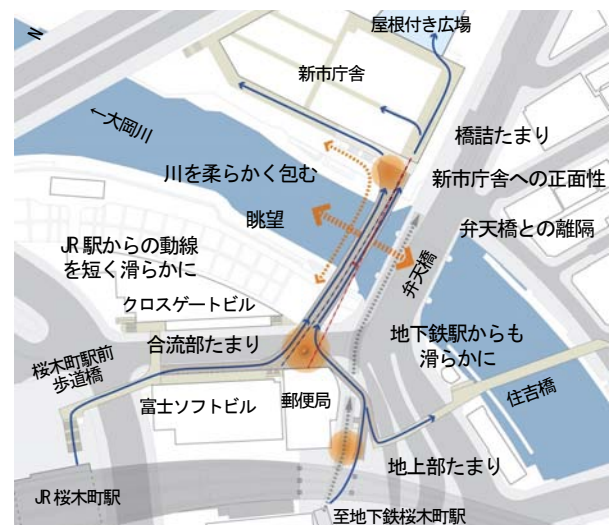
図-5 平面線形の考え方(プロポーザル時の提案)
