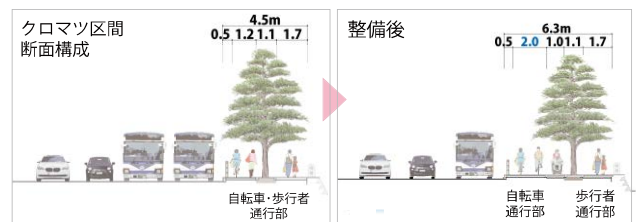
図-16 整備前後のクロマツ区間横断構成
