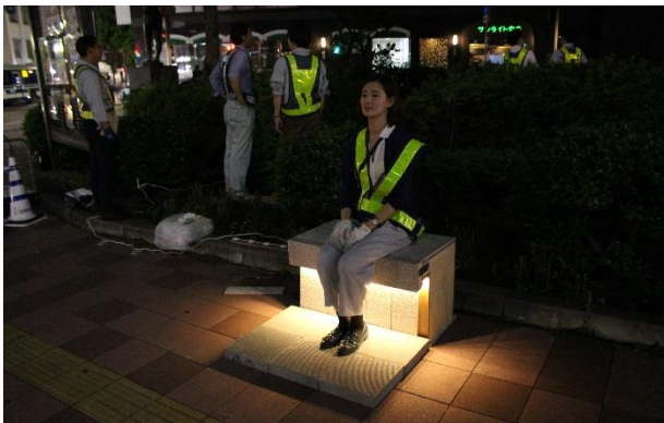
図-12 実物大模型による照明イメージの検討
