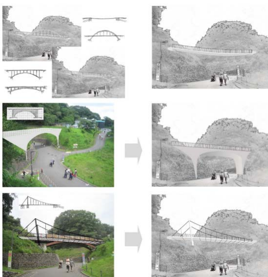
図-3 橋梁形式選定のラフスケッチとフォトモンタージュ
