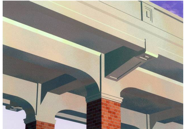
図2 複線式のブラケット部と高欄の詳細(図1・2の出展は『鉄道高架橋の景観デザイン』景観デザイン研究会, 1999-8)
