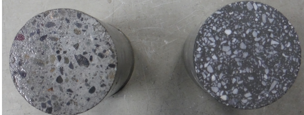
図-3 モルタル供試体 (左:陸砂, 右:石灰砕砂)
