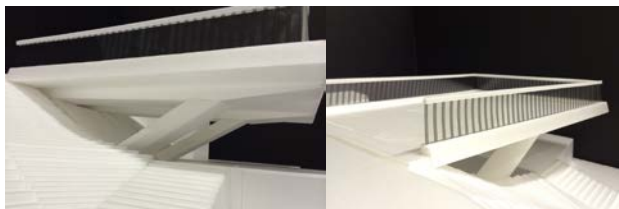
写真-4 模型による展望場の構造検討と造形検討
