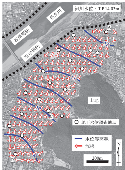
※水位等高線に併記した数値は地下水位(TP.m) 図-4 地下水位 (TP.m) 等高線 (2014年8月)
