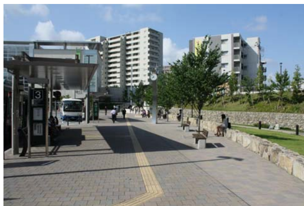
図-6 駅前広場のバス待合の様子。バス待合は乗降部に準備したシェルター下のベンチに加え、木陰が準備された石の腰壁にたたずみながらバスや人との待ち合わせることができる。設計で与えられた道路区域は整形であるが、隣接する広場と一体的にデザインすることで、自然で豊かな待合空間を提供することができる。
