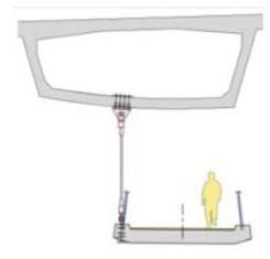
(d) 桁下区間：吊りケーブル
