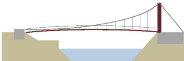
図-6 第④案鋼製吊橋案
