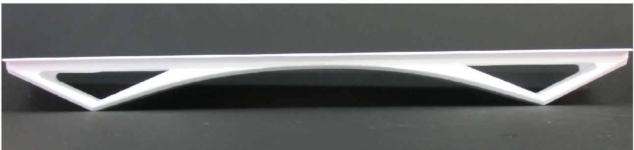
写真-7 最終のアーチリブ造形(そぎ落とし250mm)
