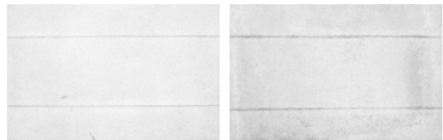
写真-17 クリア塗装による表面曝露試験の6ヶ月経過した様子(左:塗装あり 右:塗装なし)
