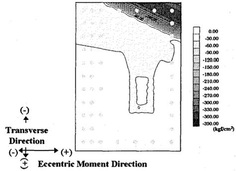
Fig. 18.2 Concrete Stress at  $-2 \delta y (1)$
