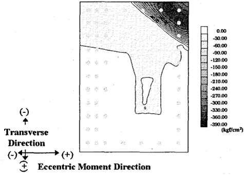
Fig. 18.6 Concrete Stress at  $-2 \delta y (3)$
