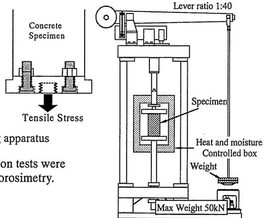
Fig.-3 Creep test apparatus
