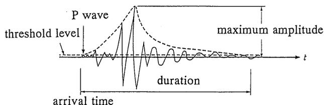
Fig. 7 AE waveform parameters
