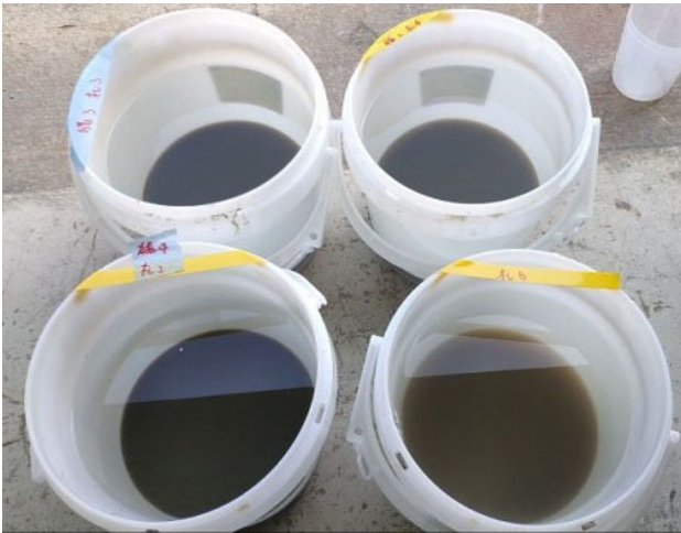
図-4 浄水場沈殿池のスラッジ
