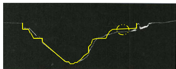
図-9 地震前後の阿蘇大橋地形断面図
