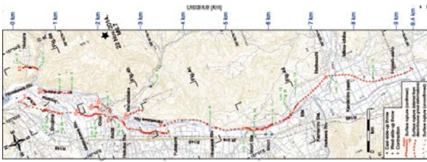
図-2 2014年長野県北部の地震における地表断層変位分布 2)
