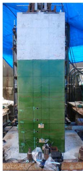
写真-2 AFRPシート巻立て後の補修試験体
