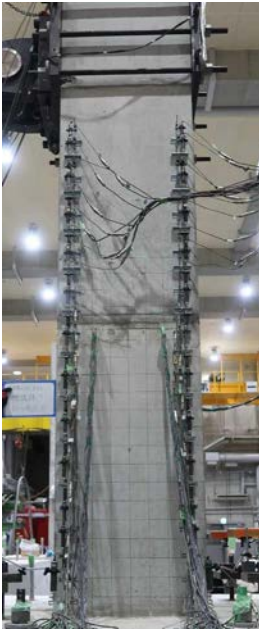
図-4 鉛直変位計測の様子
