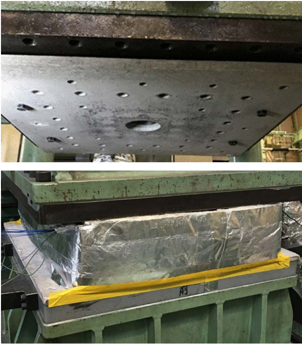
図-3 試験体上の断熱材と低温チャンバー
