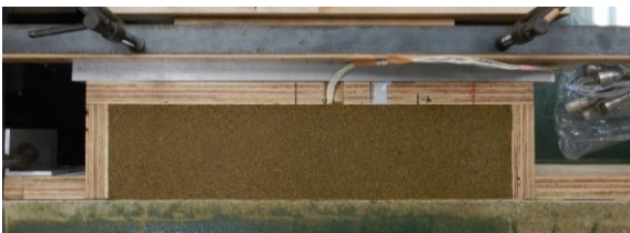
(b) 締め固め完了
