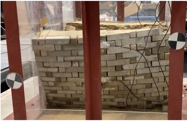
(a)ブラフ擁壁（傾斜角度 0^{\circ} ）：250Gal崩壊
