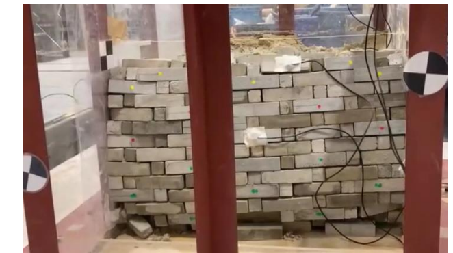
(h)アンカー補強（ l=25\sim 60\text{cm} ）700Gal崩壊
