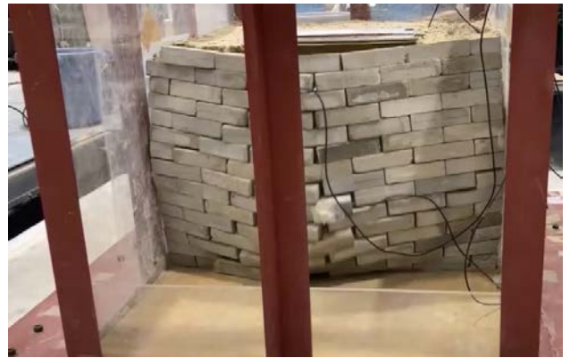
(f)長手積擁壁（傾斜角度 4^{\circ} ）：200Gal崩壊
