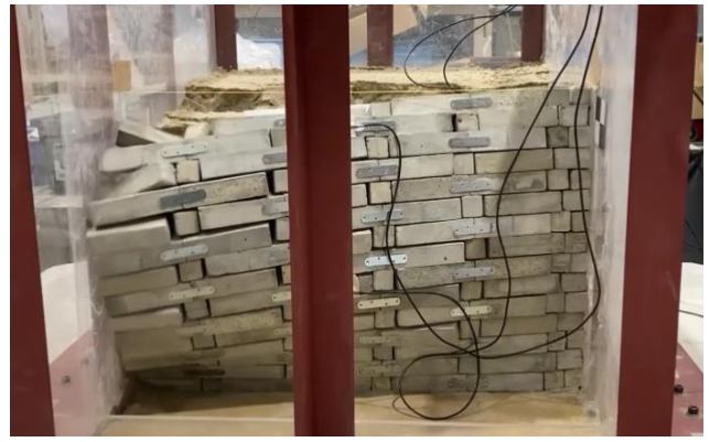
(e)Wブラフ連結補強(傾斜角度 4^{\circ} )：350Gal崩壊
