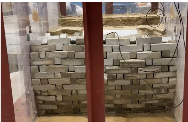
(c)ブラフ擁壁（傾斜角度 12^{\circ} ）500Gal崩壊
