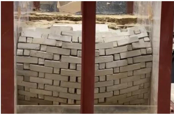
(b)ブラフ擁壁（傾斜角度 4^{\circ} ）：300Gal崩壊
