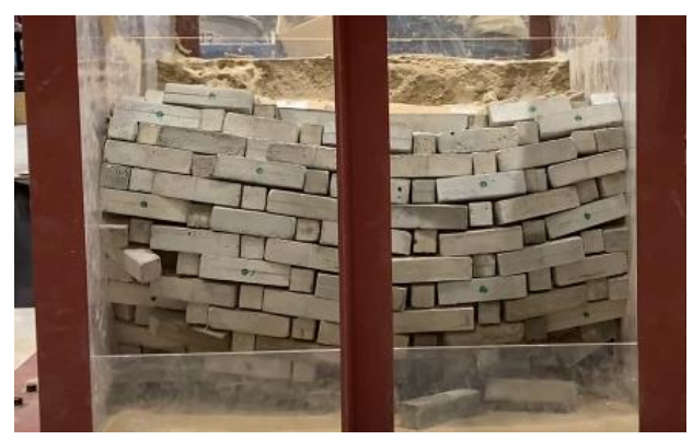
(g)アンカー補強（ l=30\text{cm} ）600Gal崩壊
