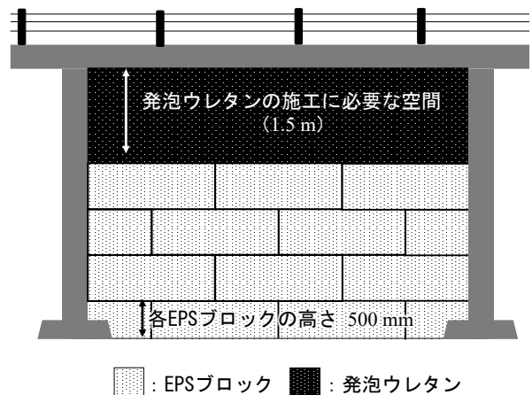
図-2 FS 工法の中詰め状態
