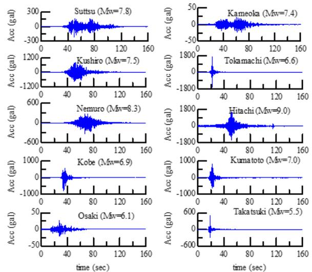
図-6 観測地震記録の加速度時刻歴波形
