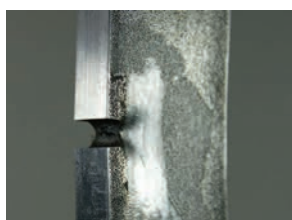
(b) き裂発生
