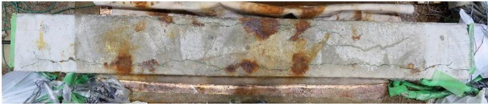
図-10 腐食促進終了の腐食一取替型供試体
