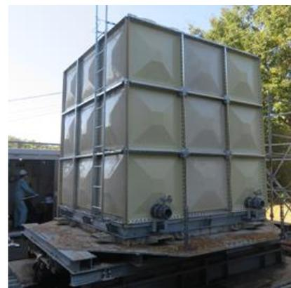
写真-1 非耐震 FRP 製貯水槽（FRP タンク）
