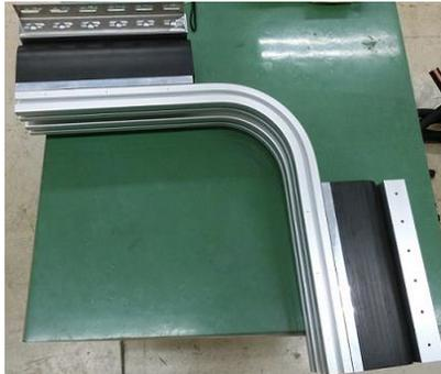
写真-2 バルジング用制振装置
