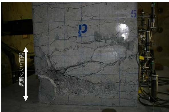
(c) 7δ<sub>y</sub> 載荷終了後（限界状態3）の柱基部の損傷状況
