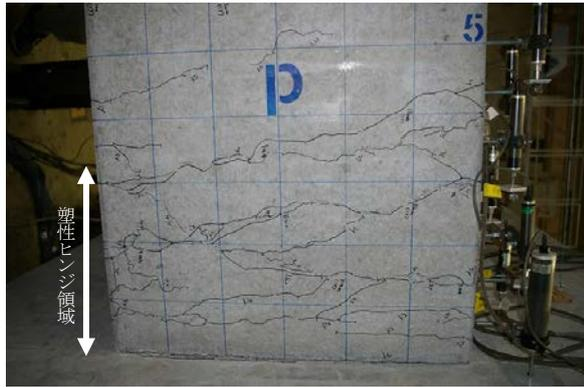
(a) 5δ<sub>y</sub> 載荷終了後（限界状態2直前）の柱基部の損傷状況
