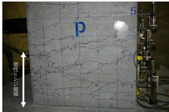
(b) 6δ<sub>y</sub> 載荷終了後の柱基部の損傷状況
