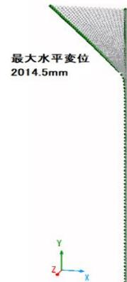
図-28 地中杭の水平変位分布
