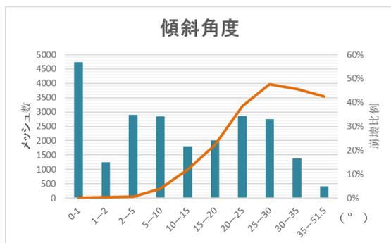
図-6 傾斜角度ごとのメッシュ数と斜面崩壊率
