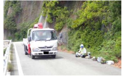
写真-1 車両走行振動測定状況
