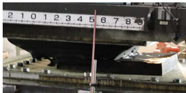
写真-1 ゴム支承の水平載荷実験(ゴム支承破断時)
