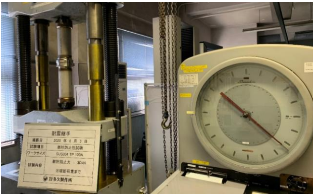
図-9 離脱防止性試験の様子
