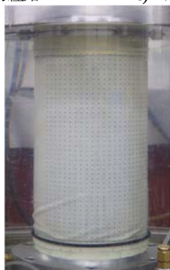
f) 载荷終了後の供試体状況 ( \gamma_{DA}=15\% )
