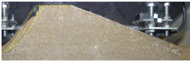
図-5 滑り破壊の様子 9)
