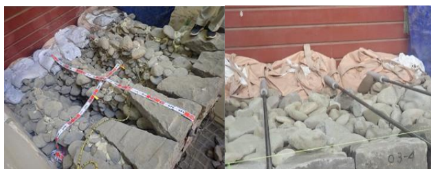
写真-5 筒状固結アンカー工法モデルの状況
