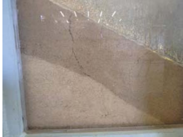
(b) 浸透領域に生じたすべり線
