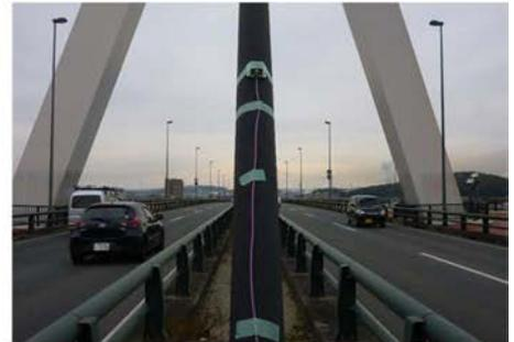
スペクトルは容易に捉えることができるが、1次及び2次モードの最大変位位置からは離れているため、常時微振動を利用した計測では、多くのノイズに埋もれてスペクトルを判別できなくなることもあり、この対応として強制加振が必要となる。
