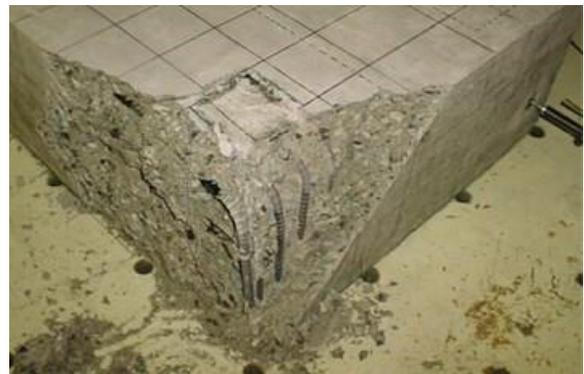
図-23 二方向実験破壊面
