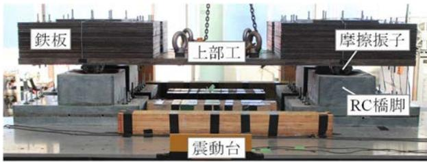
写真-1 大型橋梁模型の設置状況 (左右：橋軸方向)
