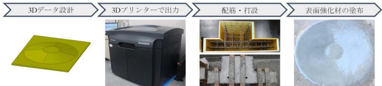
図-9 滑り面付き RC 橋脚の製作フロー
