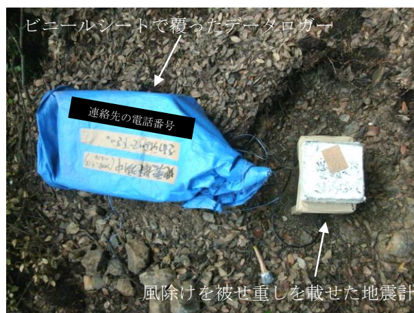
図-4 地震計設置状況
