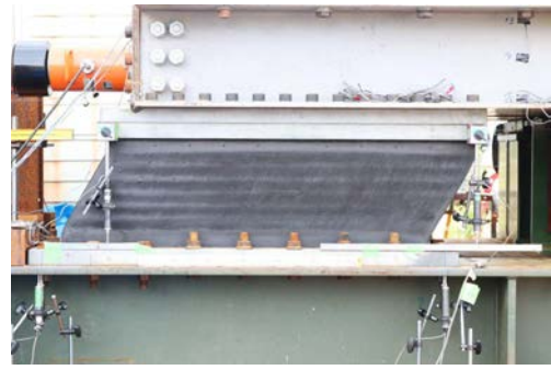
写真-8 せん断ひずみ 70%試験状況
