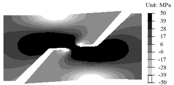
図-6 解析結果の応力分布 (変形倍率 50 倍)
