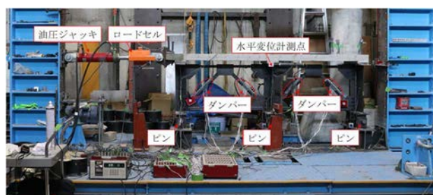
図-10 鋼上部構造载荷実験の試験システム
