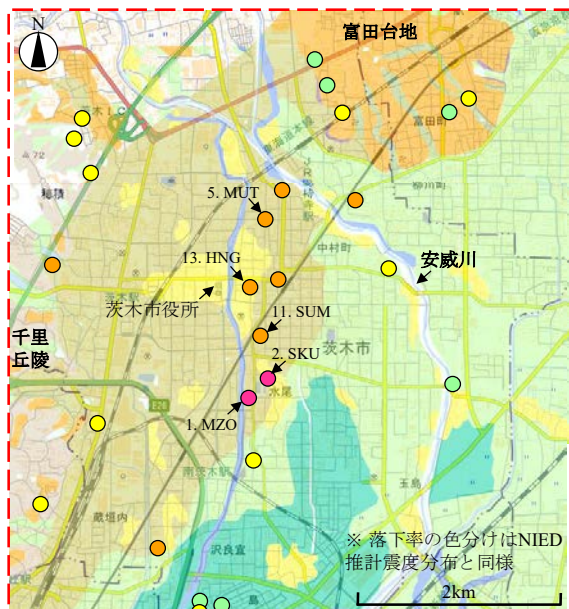
(b) NIED推計震度分布 3) と墓石による震度分布
