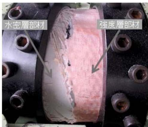
図-12 No.3 強度層部材破断状況
