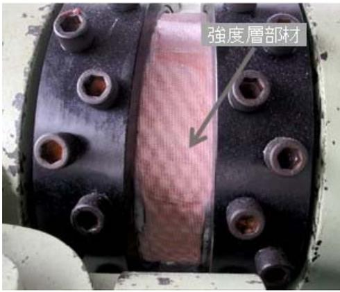
図-11 No.3 曲げ実験状況 曲げ部拡大
