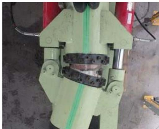
図-10 曲げ実験状況 (16度)
