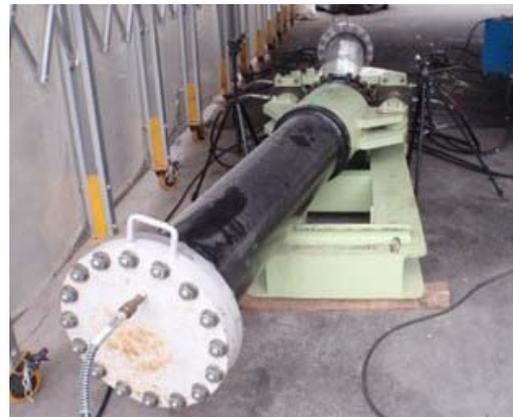
図-9 曲げ実験状況
